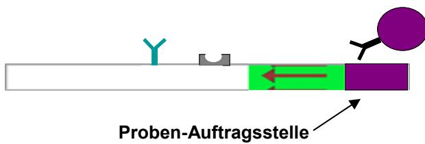
2) Zugabe von Probe und Analyt-spezifischer Lösung
